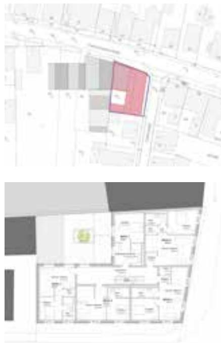
Bei dem Neubau in Bremen-Grohn handelt es sich um ein Wohnhaus mit 10 1–2-Zimmer-Wohnungen. Der B-Plan 395 weist eine geschlossene Bauweise aus. Die Umgebung ist überwiegend durch 1–3-geschossige giebelständige Gebäude geprägt. Das Gebäude hat zwei Vollgeschosse und ein Dachgeschoss.
